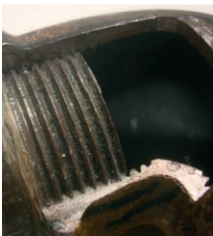
1. Przekrój instalacji skręcanej doszczelnionej polimerem
